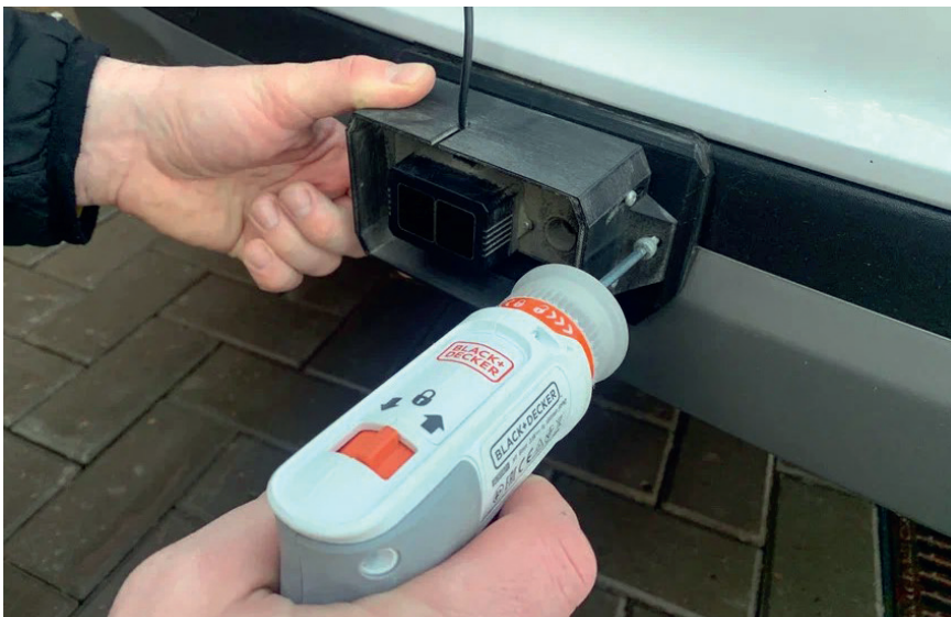
Рис. 4. Установка лазерного дальномера на испытательное транспортное средство
