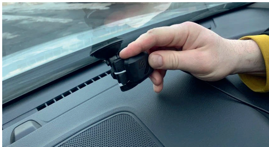
Рис. 5. Установка модуля ГЛОНАСС/GPS BDS v3
